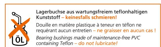
Lagerbuchse aus wartungsfreiem teflonhaltigen Kunststoff – **keinesfalls** schmieren!
