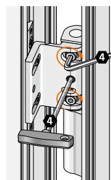
Mit zweitem Inbusschlüssel Befestigungsschrauben wieder anziehen (9–11 Nm).
