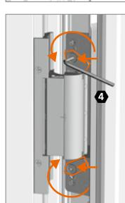
Riegel lösen, ausschwenken und festziehen.
