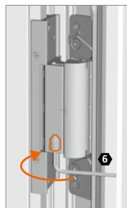
Untere Verstellspindel bei allen Bändern lösen.
