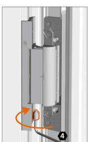
Untere Verstellspindel bei allen Bändern ein-drehen.
