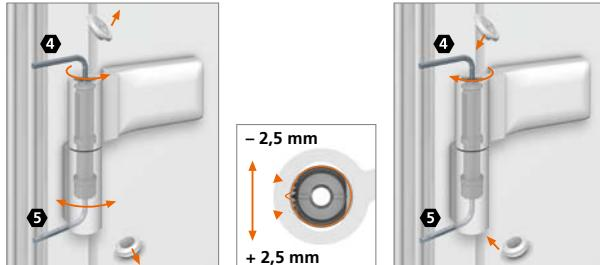
Abdeckkappen abnehmen. Sonderschraube leicht lösen. Dichtungsdruck einstellen und in Position halten. Sonderschraube festziehen (max. 4 Nm) und Abdeckkappe aufsetzen.
