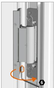
Untere Verstellspindel bei allen Bändern demontieren.
