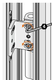
Befestigungs-schrauben Flügelbandteil leicht lösen.
