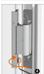
Untere Verstellspindel bei allen Bändern ein-drehen.
