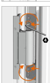
Riegel lösen, ausschwenken und festziehen.
