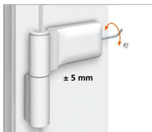
Stopfen entfernen. Stufenlose
